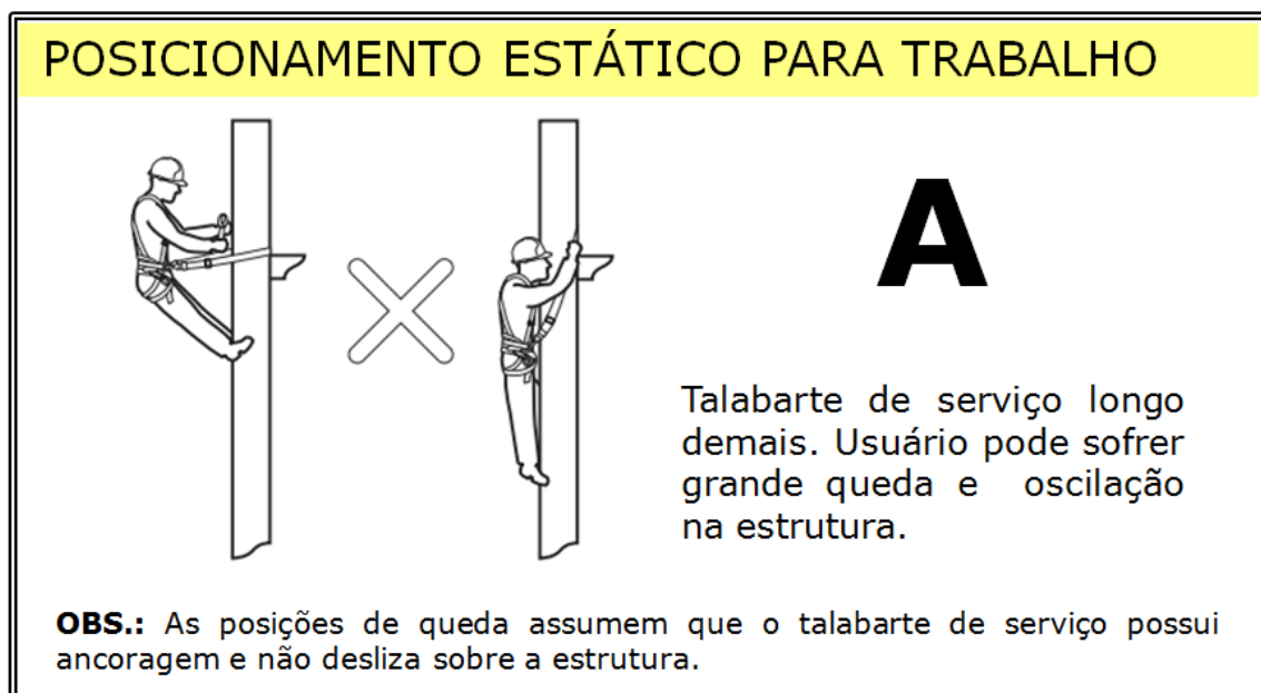
Figura 9 - Modo incorreto para posicionamento de trabalho.
