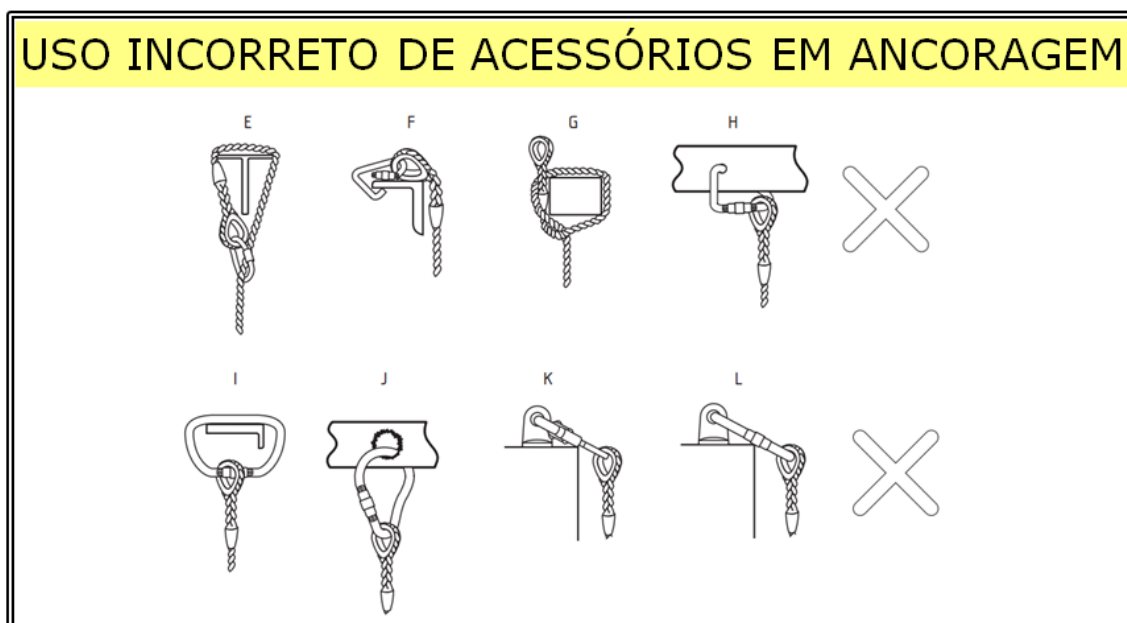
Figura 16 - Instalação incorreta de acessórios em pontos de ancoragem.
